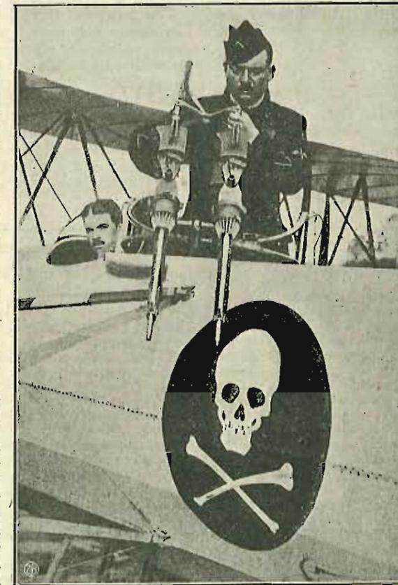
Doppia mitragliatrice per aeroplani. — Si tratta di due mitragliatrici distinte, ciascuna con canna propria e proprio serbatoio, ma riunite in modo da risultare sempre parallele, e da permettere manovra e caricamento con meccanismo unico. Il puntamento avviene per mezzo di una sola delle due mitragliatrici, a scelta: il che sarebbe assurdo se la distanza fra le due canne (meno di mezzo metro) non fosse piccola relativamente alle dimensioni del bersaglio e se il tiro non avvenisse a ventaglio.
